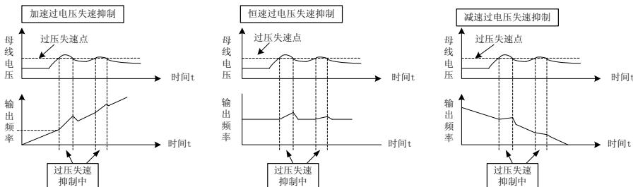
图 6-10 过压失速动作示意图
