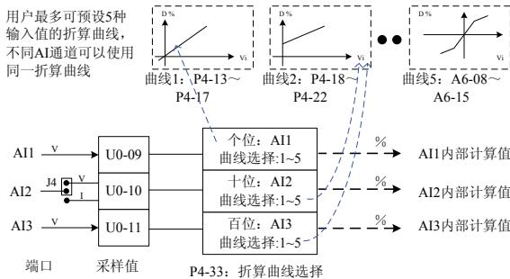
图 4-30 AI 信号对应实际给定
