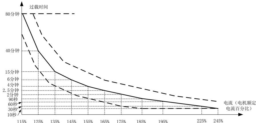
图 6-32 电机过载保护反时限曲线示意图
