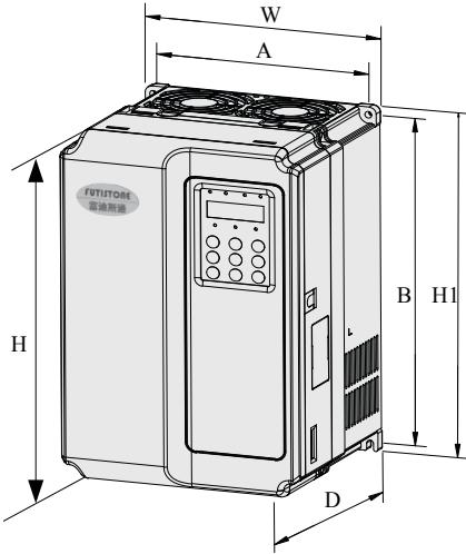
图 8-1 FTD360 系列 塑胶结构外型尺寸及安装尺寸示意图
