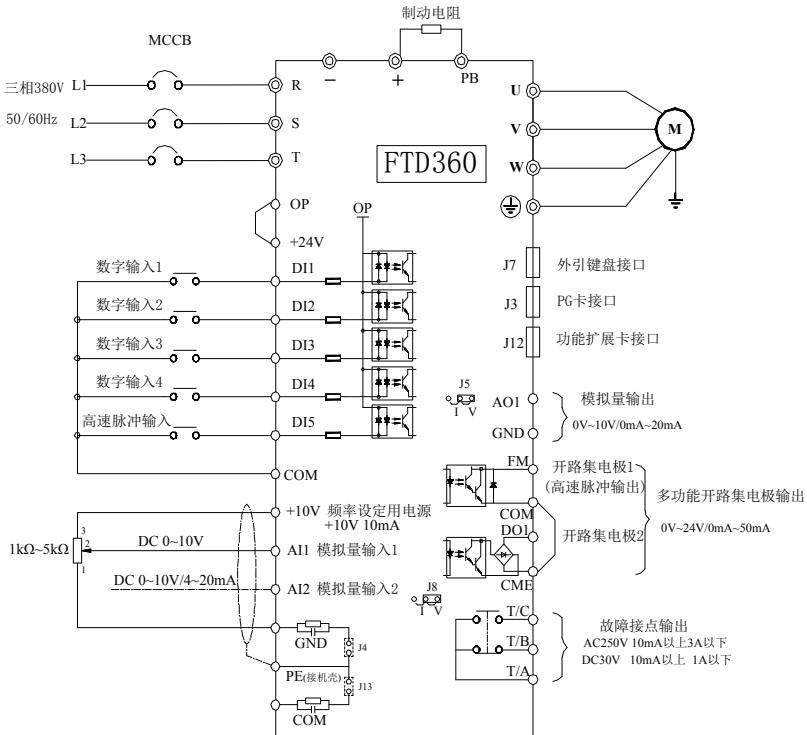
图 3-4 变频器控制回路接线方式
