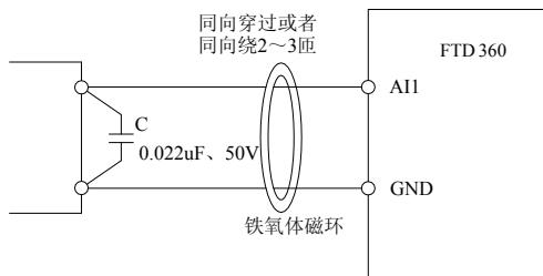
图 3-6 模拟量输入端子处理接线图
