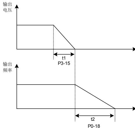
图 6-7 V/F 分离频率 / 电压先后下降示意图
