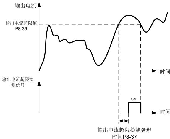
图 6-30 输出电流超限检测示意图
