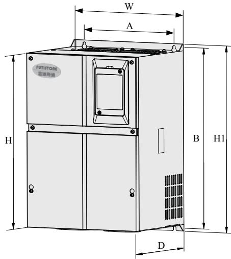
图 8-2 FTD360 系列 钣金结构外型尺寸及安装尺寸示意图
