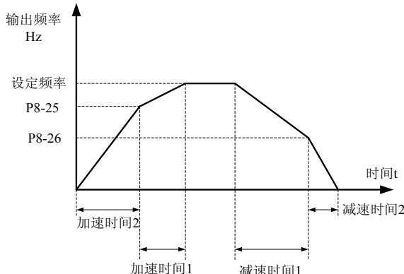
图 6-27 加减速时间切换示意图
