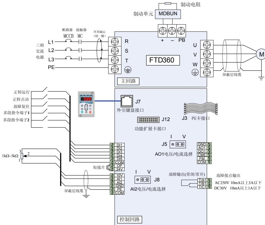
图 3-11 FTD360电气接线示例
