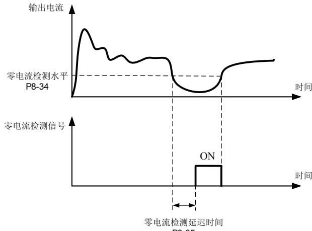
图 6-29 零电流检测示意图
