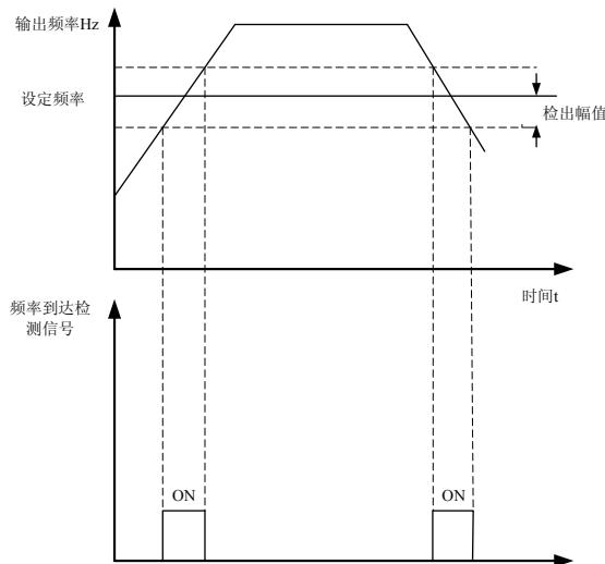
图 6-25 频率到达检出幅值示意图
