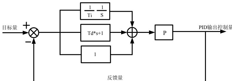
图 6-34 过程 PID 原理框图
