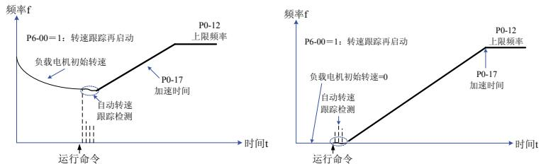
图 4-9 速度跟踪再启动方式
