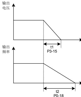
图 6-6 V/F 分离输出电压 / 频率独立减至 0
