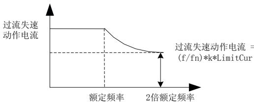
图 6-9 倍速过流失速动作示意图
