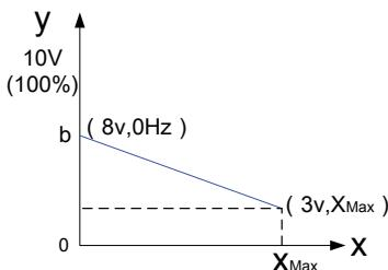
零偏  $b = y - kx = y (x=0 \text{ 时}) = 8V$  零偏系数 100% 时对应 10V，故  $b=8V$  时对应的零偏系数  $= \frac{8V}{10V} \times 100\% = 80\%$
