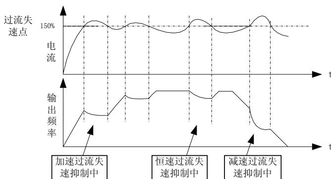
图 6-8 过流失速动作示意图
