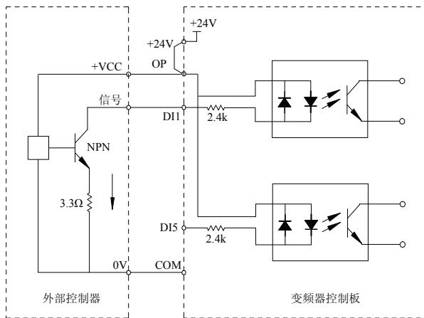
图 3-7 漏型接线方式
