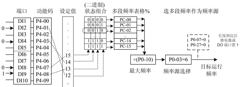
图 4-24 多段速模式的設置
