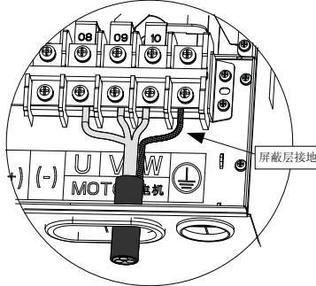
图 7-2 屏蔽电缆接地示意图
