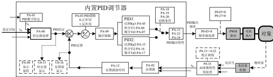
图 4-22 过程控制的频率闭环控制
