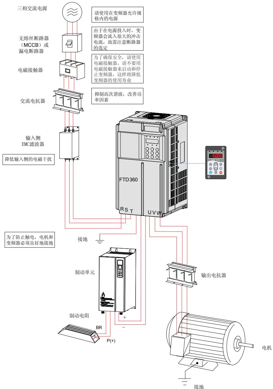
图 2-4 系统构成图
