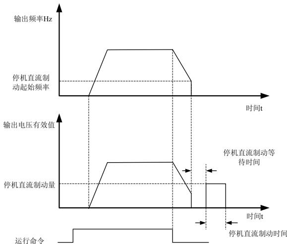
图 6-21 停机直流制动示意图
