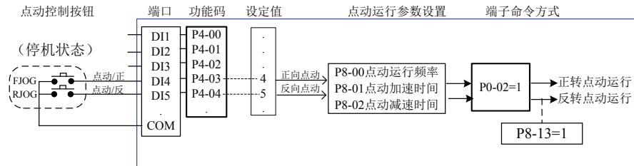
图 4-15 通过 DI 端口点动运行
