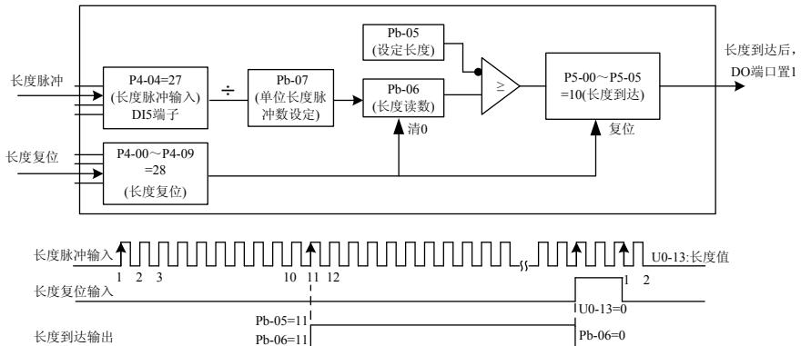
图 4-26 定长控制模式功能码设置
