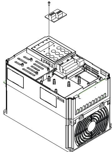
附录 B：图 1 FTD36IO2 安装方式
