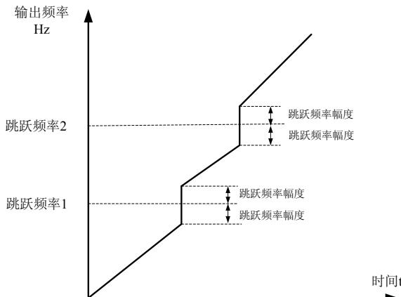
图 6-26 加减速过程中跳跃频率有效示意图
