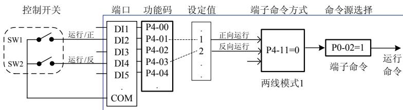
图 4-5 端子启停控制方式举例
