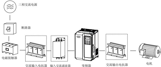
图 7-1 EMC 外围配件安装示意图 (虚线框所示)
