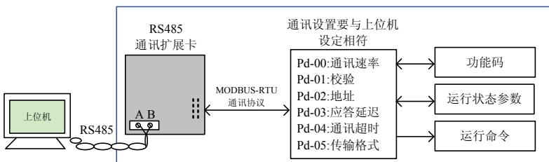
图 4-31 变频器串行通讯的使用
