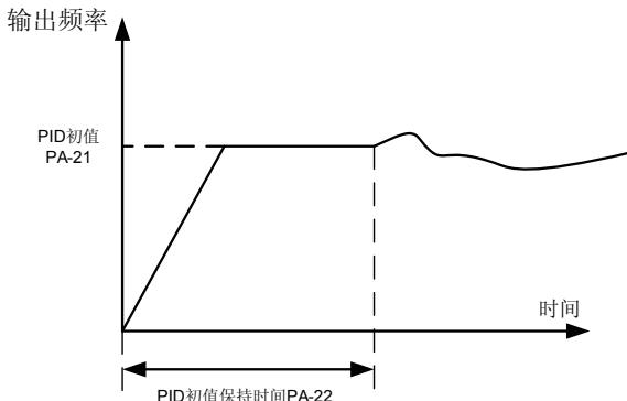
图 6-36 PID 初值功能示意图
