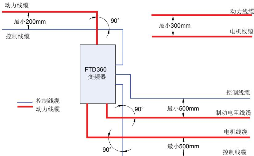
图 7-3 电缆布线图
