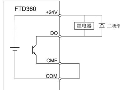
图 3-10 数字输出端子接线示意图
