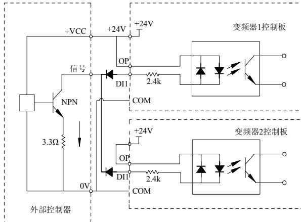
图 3-8 多台变频器 DI 端子并接漏型接线方式
