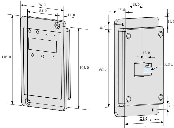
图 8-16 外引键盘的外型尺寸 (单位: mm)
