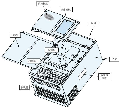
图 2-3 FTD360 系列变频器钣金结构外型图
